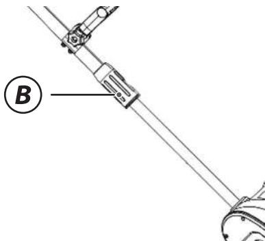
Для регулировки нижней рукоятки ослабьте барашковую гайку (B) и установите ручку (A) в удобное для вас положение.
