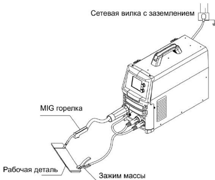
Рис. 3.2 Схема подключения в режиме MIG (сварка порошковой проволокой NO GAS).
