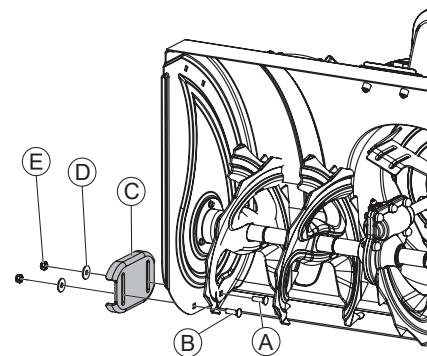
Для предохранения от повреждений частей ковша снегоуборочной машины установите башмаки по его обеим сторонам. Используйте детали крепежа из бокса №16: (A) болт M8×25 – 2 шт.; (B) болт M8×20 – 2 шт.; (D) гроверная шайба D8 – 4 шт.; (E) Гайка M8 – 4 шт.
