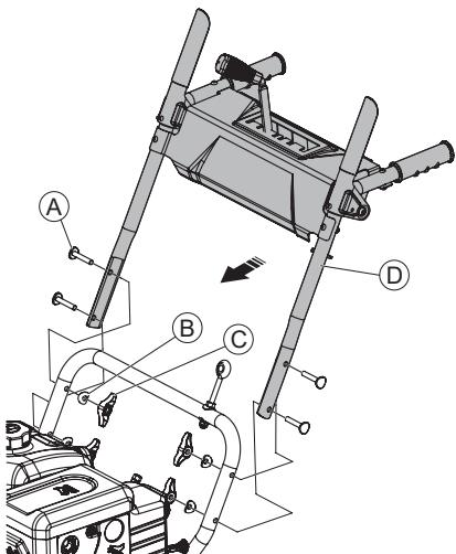
Совместите отверстия нижней и верхней рукояток, и закрепите при помощи болтов и пластиковых барашковых гаек. Используйте крепёжные элементы - бокс №3: (A) болт M8x50 – 4шт.; (B) фигурная шайба – 4 шт.; (C) барашковая гайка M8 – 3 шт. Затяните болты от руки. Закрепите трос привода шнеков.
