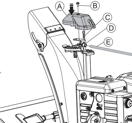
Проденьте рукоятку поворота желоба (A) через хомут (B) нижней рукоятки и установите её в отверстие рулевого механизма, зафиксируйте штифтом. Установите декоративную крышку (A) и зафиксируйте ее. Используйте крепеж из бокса №10: (B) болт M6×12 – 1 шт.; (C) шплинт – 1 шт.
