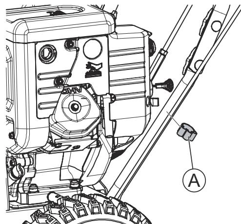
После установки верхней рукоятки закрепите трос привода шнека при помощи пластиковой клипсы (A) из бокса №5.
