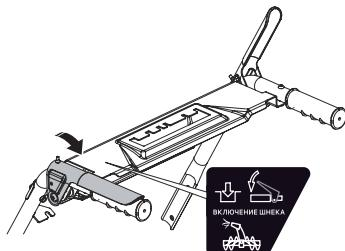
Нажмите на рычаг привода шнека по направлению к ручке управления, шнек начнет вращение и можно начинать расчистку снега. Для отключения шнека отпустите рычаг. При выключенном положении рычага трос должен находиться в свободными состояниями, но без провисания. Шнеки начинают вращение при нажатии на рычаг  $\frac{1}{3}$  от его полного хода. В случае необходимости следует отрегулировать натяжение тросов.
