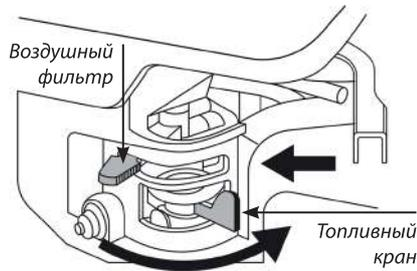
**Примечание!** Для повторного запуска горячего двигателя возможно оставить рычаг воздушной заслонки в положении «**OPEN**» (**ОТКРЫТО**).
