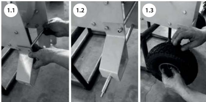
**Шаг 2** - Опорные ножки и крышка разгрузочного бункера.
