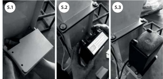
Подключите клеммы проводов питания к аккумулятору. Кабель красного цвета крепится к клемме «+»
