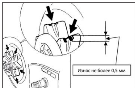
Рис. 16 Проверка износа звездочки
