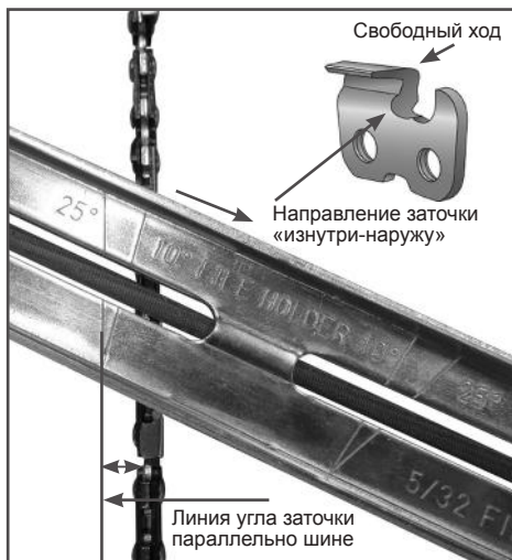
Рис.18 Определение угла заточки
