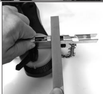
Рис. 21 Стачивание ограничителя глубины резания
