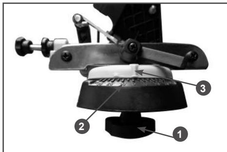
Рис. 12 Установка угла заточки
