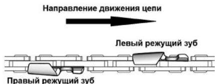
Рис. 10 Определение типа режущего зуба
