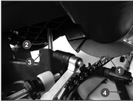
Рис. 17 Регулировка глубины заточки
