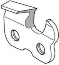
Рис. 16 Режущая кромка зуба
