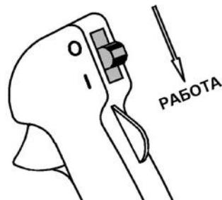
Рис. 12 Выключатель зажигания в положении «I»
