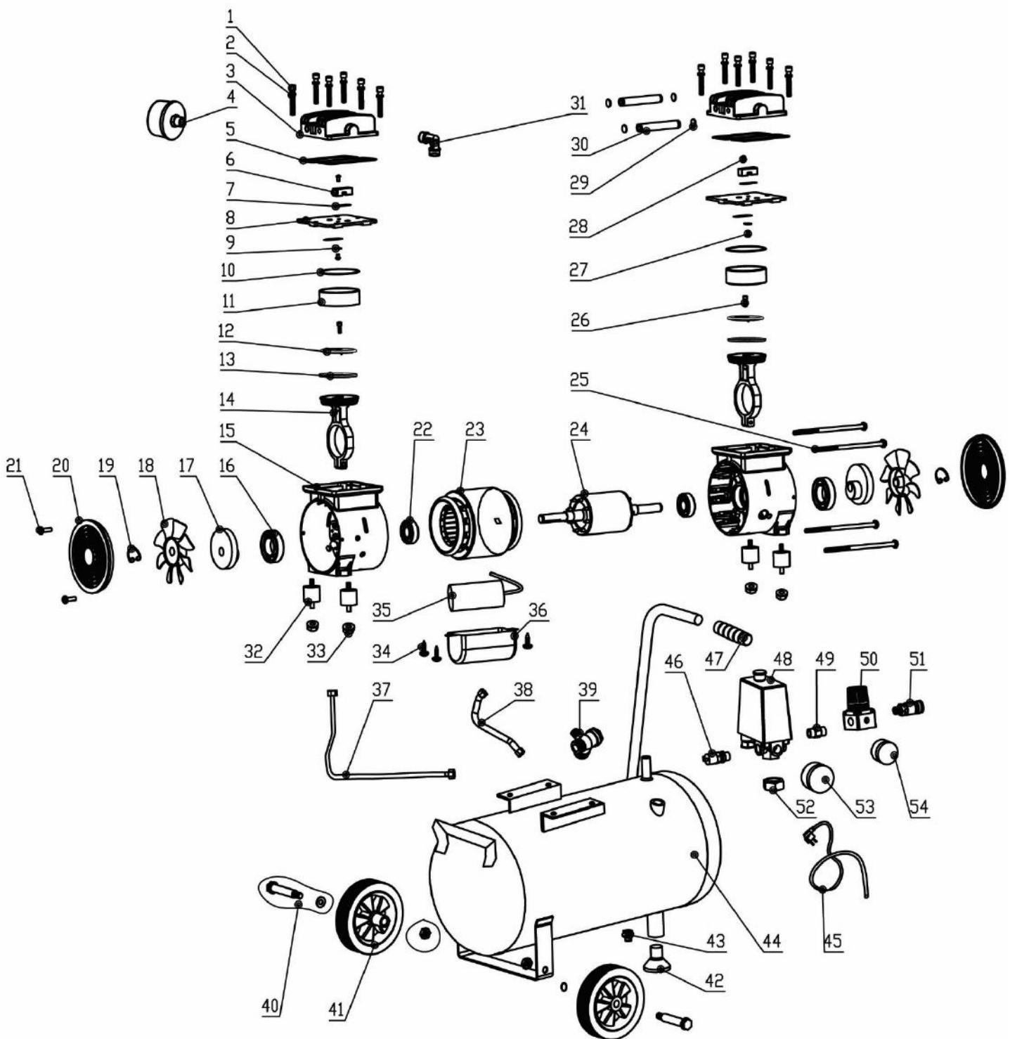
Расшифровка деталировки модели PASSAT-25
