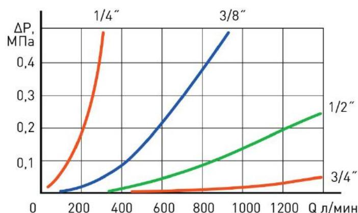
График иллюстрирует зависимость падения давления в магистрали при разной производительности компрессора. Четыре кривые иллюстрируют падение давления для гладких труб диаметром 1/4", 3/8", 1/2" и 3/4". Расчеты приведены для трубы круглого сечения длиной 10 метров.
