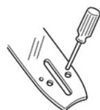
Очистку шины и проверку степени износа производите после каждой эксплуатации. Для этого снимите шину, прочистите масляные каналы, паз пильного полотна и смазочное отверстие звездочки. Внесите смазку с помощью шприца-маслёнки в смазочное отверстие звездочки.
