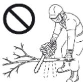
Не работайте цепной пилой, держа ее одной рукой. Последствиями работы одной рукой могут стать серьезные травмы оператора, помощников или окружающих. Для должного контроля всегда работайте цепной пилой обеими руками, одна из которых управляет выключателем. В противном случае пила может выскользнуть из рук, или ее может увести в сторону, что приведет к серьезным травмам из-за потери контроля надней.
