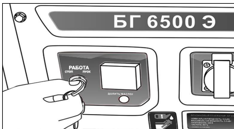
Рис. 17. Запуск двигателя электростартером
