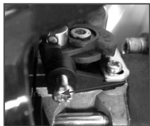
Рис. 16 Винт настройки оборотов холостого хода
