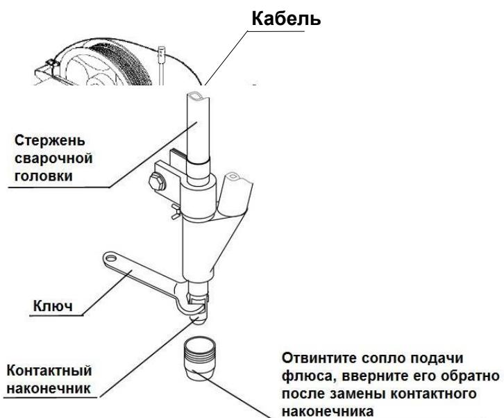
Плохой контакт между контактным наконечником и стержнем горелки приведет к плохой проводимости и нестабильной дуге. Пожалуйста, внимательно проверьте перед работой.
