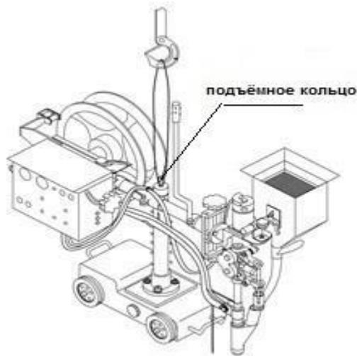
Предохраняйте сварочный трактор от воздействия прямого солнечного света и дождя. Храните сварочный трактор в месте с низкой влажностью и запыленностью. Температура окружающей среды должна быть от -10°C до +40°C. Класс защиты сварочного трактора IP2X.
