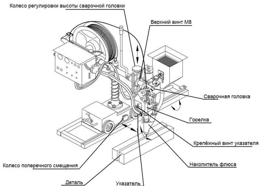
2. Установка металлического указателя. После подгонки положения сварочной головки, ослабьте крепежный винт указателя для установки его в положение на 10–15 мм выше оси стыка свариваемых заготовок, направьте указатель на сварной шов, затяните крепежный винт снова.
