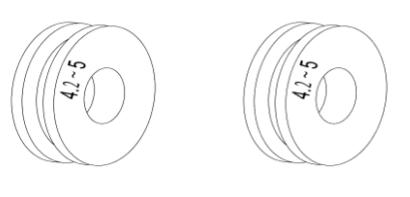
Техническое обслуживание ходового колеса: в конструкции наружного обода ходового колеса используется резина с анти-масляными, кислотно- и щелочно- стойкими свойствами, учитывающими самые разные ситуации применения. Производитель убедительно рекомендует предохранять ходовые колёса от прямого контакта с маслянистым острым железным ломом, осколками стекла, кислотными и щелочными и другими агрессивными химическими жидкостями.
