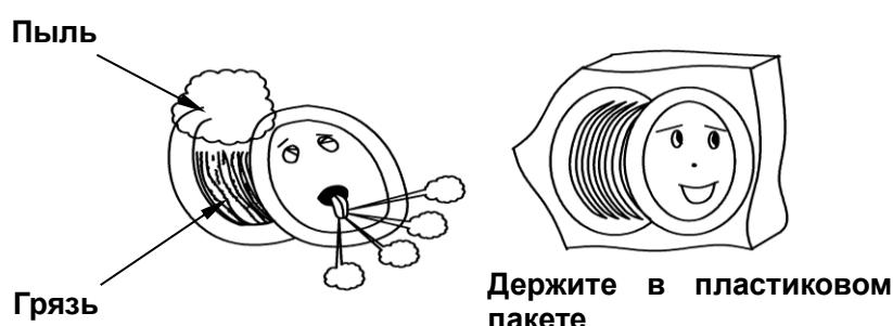
Сварочный флюс должен храниться в сухом месте. Прокалите сварочный флюс перед сваркой.
