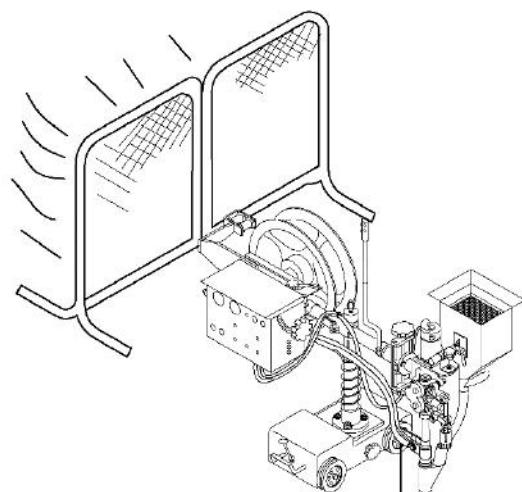
Применяйте меры защиты от опрокидывания сварочного трактора. Не устанавливайте трактор на поверхностях с наклоном более 10°.
