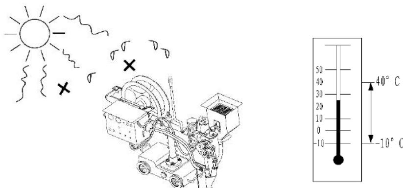
При сварке в условиях порывистого ветра следует использовать ветрозащитный механизм. При использовании вентиляторов летом не направляйте поток воздуха от вентилятора прямо на лучи дуги под соплом горелки (установите защитный экран), в противном случае очень вероятно образование дефектов сварочного шва.
