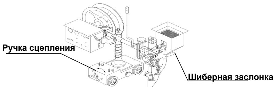
Переведите рукоятку сцепления на базе трактора в положение «ручной» и уберите трактор из зоны сварки.
