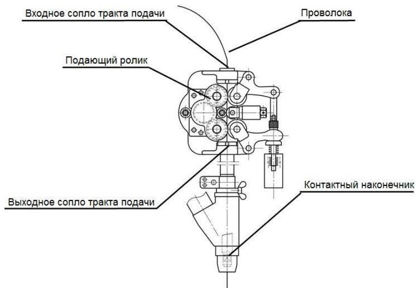
Направляющие сопла для проволоки, подающий ролик и контактный наконечник необходимо периодически очищать, удаляя грязь и пыль, накопление которых приведет к неустойчивой подаче проволоки.
