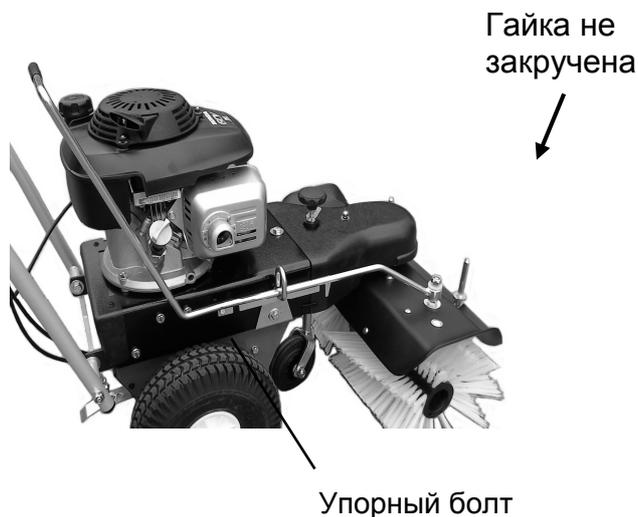
Внизу опорной планки необходимо закрутить болт М6х20 со самостопорящейся гайкой (как изображено на рисунке), при этом резьба направлена к машине. Этот болт служит в качестве упора.
