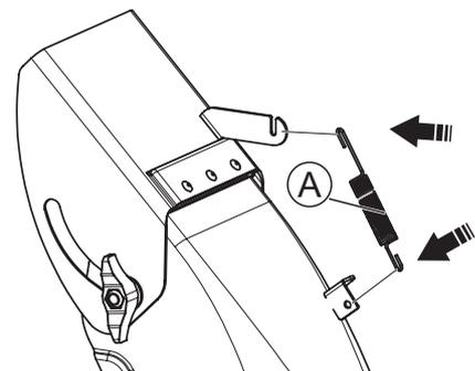
Установите возвратную пружину (А) из комплекта крепежных элементов бокс №11
