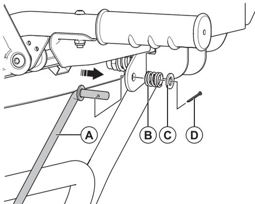
Установите на верхней рукоятке в приемное отверстие рычага переключения передач тягу (А), используйте крепежные - бокс №14: (В) пружина - 1 шт.; (С) стопорное кольцо - 1 шт.; (D) шплинт - 1 шт.
