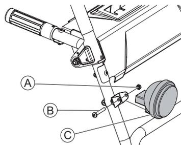
Установите фонарь освещения для этого установите его на скобу верхней рукоятки и прикрепите, используйте крепежные элементы – бокс №5: болт М6×40 – 1 шт.; гайка М6 – 1 шт
