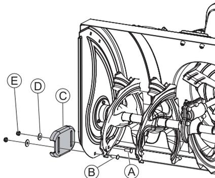
Для предохранения от повреждений частей ковша снегоуборочной машины установите башмаки по его обеим сторонам. Используйте детали крепежа из бокса №16: (А) болт М8×25 – 2 шт.; (В) болт М8×20 – 2 шт.; (D) гроверная шайба D8 – 4 шт.; (E) Гайка М8 – 4 шт.
