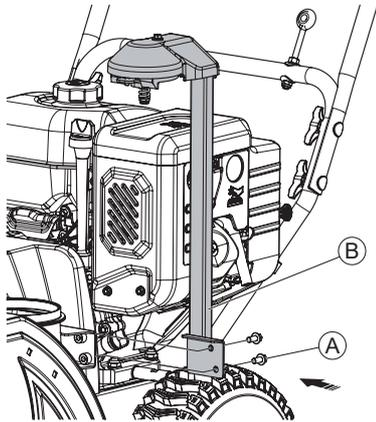
Установите поворотный механизм (B) на кронштейн снегоуборщика и закрепите при помощи болтов. Используйте крепёжные элементы из бокса №8: (A) болт M8x16 – 2 шт.
