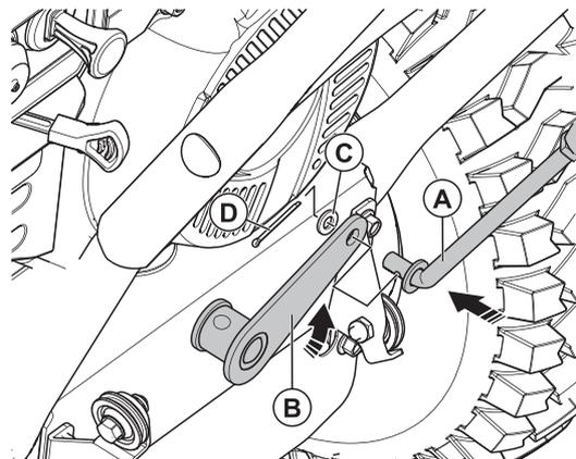
Установите на снегоуборочной машине в отверстие коннектора (В) тягу (А) и закрепите, используйте крепежные элементы - №15: (С) шайба - 1 шт.; (D) шплинт - 1 шт.
