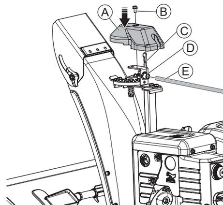
Проденьте рукоятку желоба через хомут нижней рукоятки и установите её в отверстие рулевого механизма, зафиксируйте штифтом. Установите декоративную крышку (A) и зафиксируйте её. Используйте крепеж из бокса №13: (B) болт M6×12 – 1 шт.; (C) шплинт – 1 шт.
