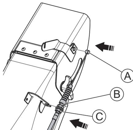
Подключите трос регулировки наклона дефлектора, проведите его через удерживающее кольцо на двигателе, затем с помощью гаек (С) и (В) зажмите его в проушине снегоотбрасывающего желоба и закрепите на дефлекторе.
