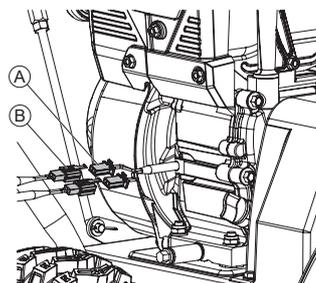
Соедините штекеры освещения и подогрева рукояток с проводом двигателя, закрепите провод на нижней рукоятке пластиковой клипсой из бокса №7. Обратите внимание, провод не должен касаться колеса.
