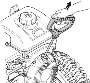
**Примечание!** Не рекомендуется вытягивать шнур стартера максимально (*на всю длину*), а также резко не отпускайте его при повторной попытке завести двигатель, удерживая рукоятку, плавно верните его в исходное положение.
