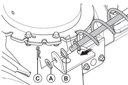
Для установки рукоятки поворотного желоба используйте крепежные элементы - бокс №5: (A) шайба - 1шт.; (B) пластиковая втулка - 1 шт.; (C) шплинт - 1шт.
