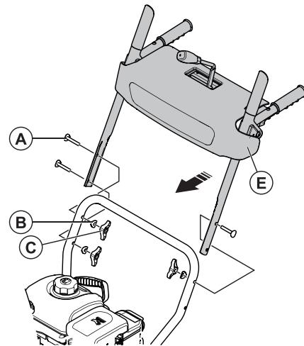
Совместите отверстия нижней и верхней рукояток, и закрепите при помощи болтов и пластиковых барашковых гаек. Используйте крепёжные элементы - бокс №3: (A) болт M8x50 – 3шт.; (B) фигуранная шайба – 3 шт.; (C) барашковая гайка M8 – 3 шт. Затяните болты от руки.
