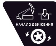
Нажмите на рычаг привода хода по направлению к ручке управления, снегоуборщик начнет движение. Для отключения привода движения отпустите рычаг.
