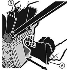
Рис. 5 Установка заглушки для мульчирования
