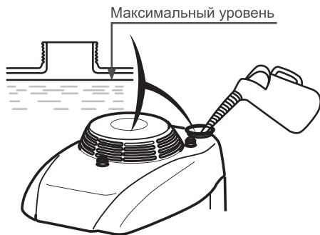
Рис. 7 Максимальный уровень топлива
