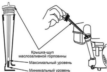
Рис. 9 Проверка уровня масла в картере
