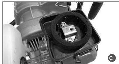
Рис. 11 Обслуживание воздушного фильтра
