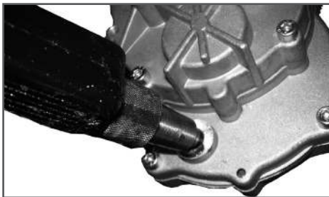
Рис. 15 Замена масла в корпусе редуктора
