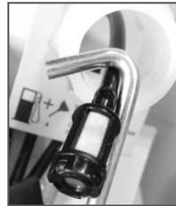
Рис. 12 Извлечение топливного фильтра
