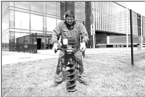
Рис. 8 Положение тела оператора при работе мотобуром
