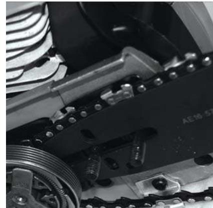
При загрязнении охлаждающих отверстий стартера продуктами распила и масляным шламом используйте для очистки кисточку и/или балон с сжатым воздухом.
