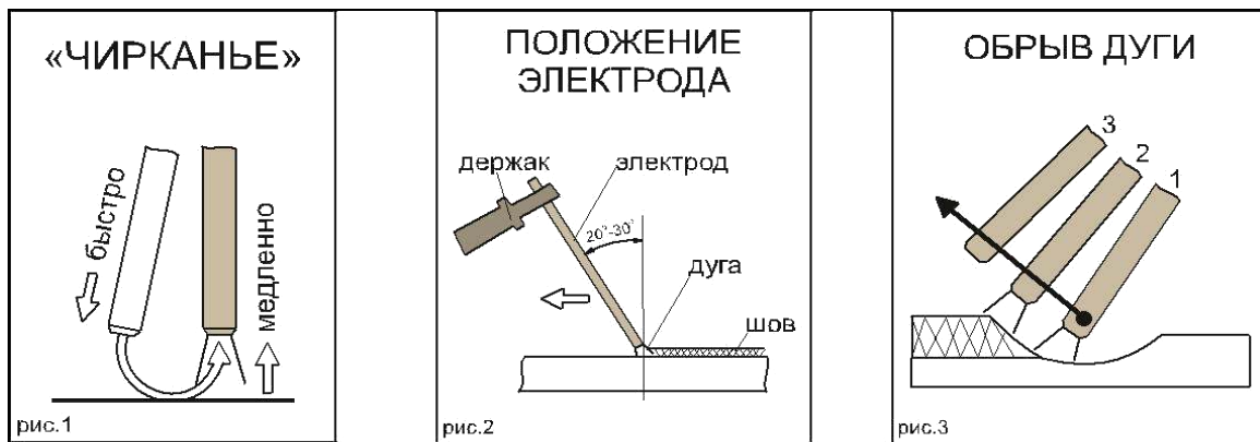
Рис. 6. Действия с электродом
