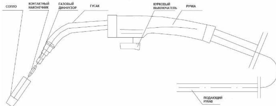
Горелка служит для подведения к месту сварки проволоки, газа и напряжения. С помощью гибкого подающего рукава проволока, газ и напряжение подаются на сварочный пистолет.
