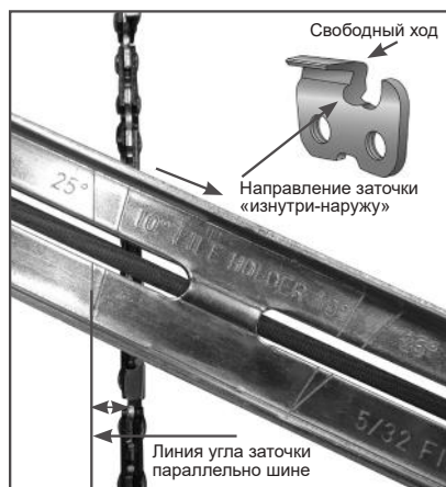
Рис. 37. Определение угла заточки
