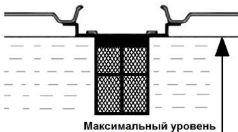
Рис. 10 Максимальный уровень топлива в топливном баке
