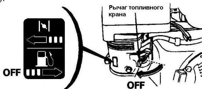
Рисунок 12 – Рычаг топливного крана в положении "OFF" ("Выключено")
