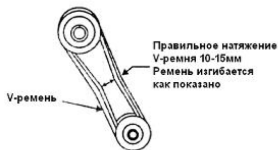
Рис. 2 Натяжение V-ремня
