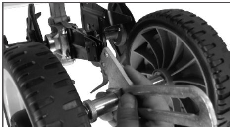
Рис. 6 Установка кронштейна колес
