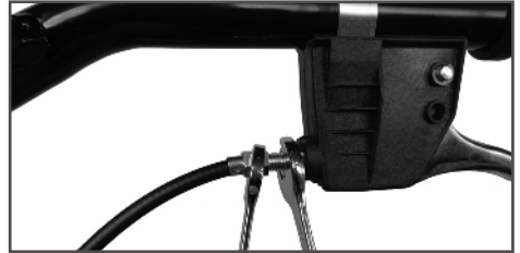
Рис. 10 Фиксация троса газа
