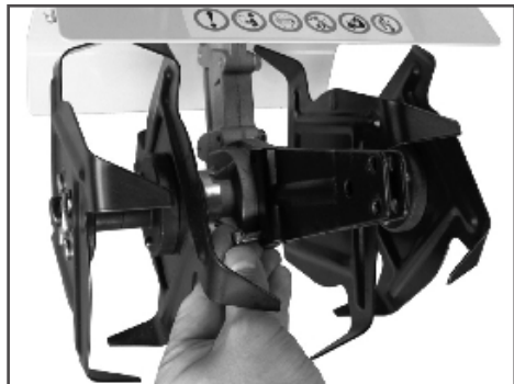
Рис. 5 Установка кронштейна сошника
