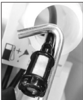
Рис. 17 Извлечение топливного фильтра
