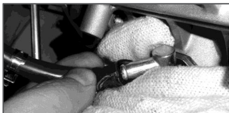
Рис. 10 Удаление воздуха из топливного шланга
