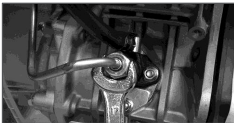
Рис. 12 Удаление воздуха из топливного насоса
