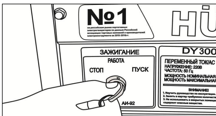
Рис. 17. Запуск двигателя электростартером
