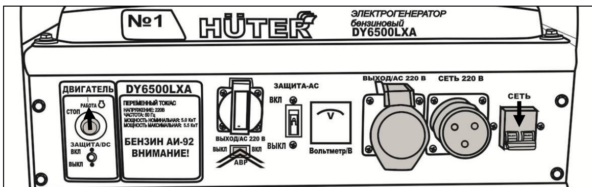
Рис. 21. Панель генератора с встроенным АВР.
