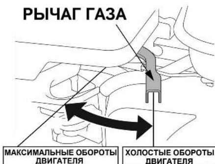
Рис. 9. Положения рычага газа
