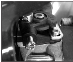
Рис. 16 Винт настройки оборотов холостого хода
