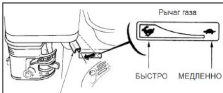
Рис. 20 Установка рычага газа
