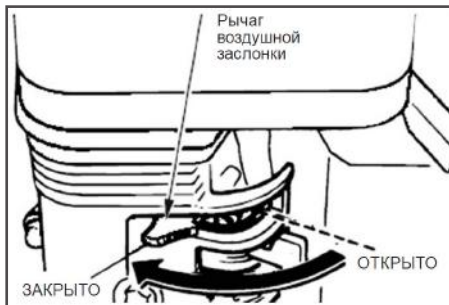
Рис.19 Установка рычага воздушной заслонки
