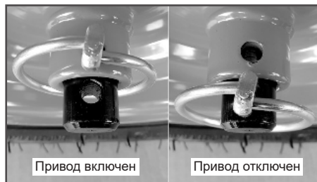
Рис.26 Перестановка шплинта на левом колесе
