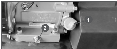
Рис.28 Замена моторного масла
