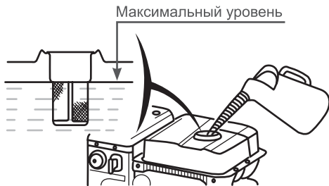
Рис. 14 Максимальный уровень топлива в баке
