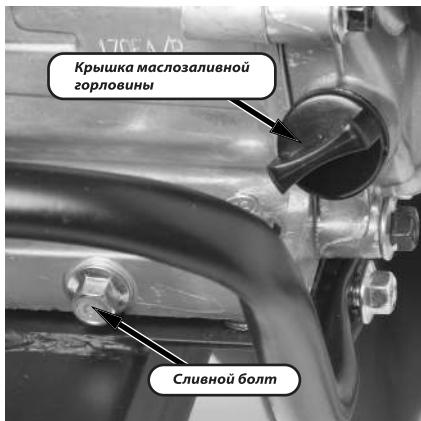
Открутите болт сливного отверстия и крышку маслозаливной горловины. Слейте отработанное масло. Производите замену моторного масла первый раз после 5 моточасов работы. Периодичность замены моторного масла во время эксплуатации мотоблока - каждые 50 моточасов работы или 1 раз в сезон.
