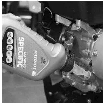
Закрутите болт сливного отверстия. Залейте новое масло до уровня, указанного на щупе. При эксплуатации мотоблока при сильной нагрузке или при повышенной температуре окружающего воздуха масло следует заменять каждые 25 моточасов. Помните, что мотоблок поставляется без моторного масла в двигателе.
