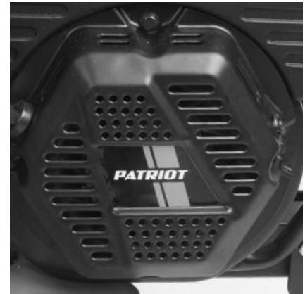
При загрязнении охлаждающих отверстий стартера продуктами культивации почвы, пылью, масляным шламом используйте для очистки кисточку и/или баллон со сжатым воздухом.
