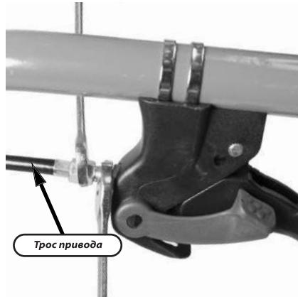
Со временем тросы привода могут растянуться. Для их регулировки необходимо расконтрить гайку и добиться оптимального натяжения тросов. Оптимальной регулировкой троса является начало движения мотоблока при нажатом рычаге сцепления на  $\frac{1}{3}$ .
