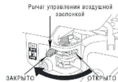
2. Закройте воздушную заслонку карбюратора. Для этого переведите рычаг управления воздушной заслонкой в крайнее левое положение.
