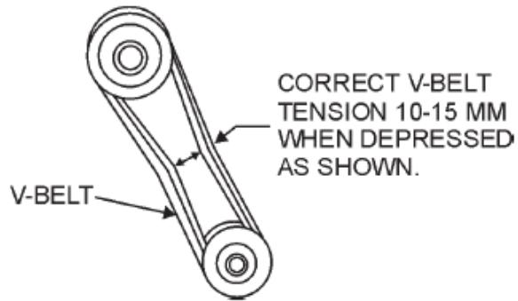
4.7. Проверку натяжения ременной передачи. В середине между колесами, при нажатии пальцем, люфт должен составлять около 10-15 мм.
