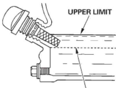
4.2. Контроль необходимости смены масла в двигателе, смену масла производить на теплом двигателе.
