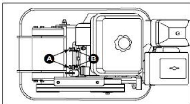
2. Ослабьте зажимные гайки В, оставляя достаточно пространства между гайкой и скобой.
