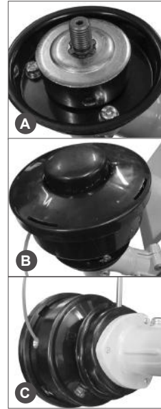
Рис. 6 Установка триммерной головки
