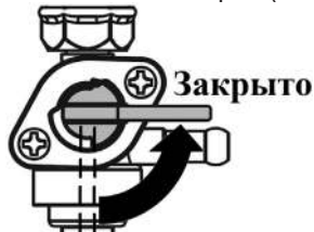
Рис. 7 Топливный кран закрыт
