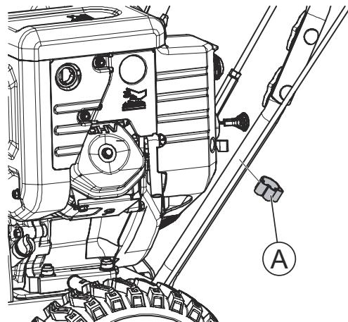
После установки верхней рукоятки закрепите трос привода шнека при помощи пластиковой клипсы (А) из бокса №5.
