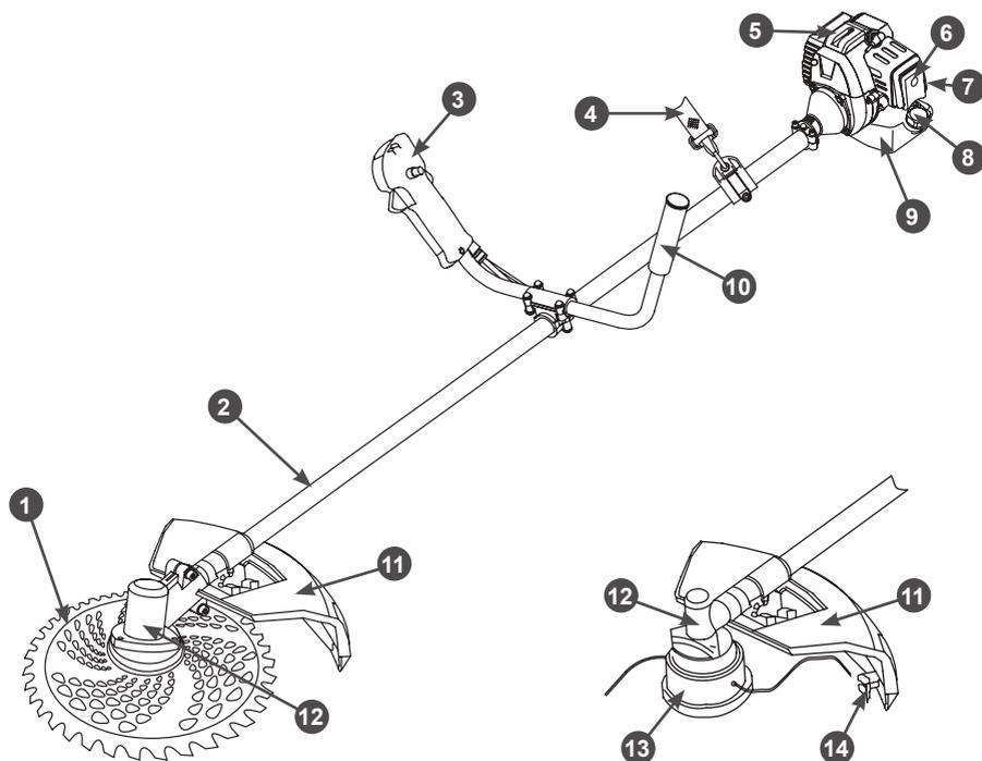
Рис. 1 Основные узлы и органы управления триммера
