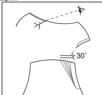
Рис. 19 Обслуживание ножа
