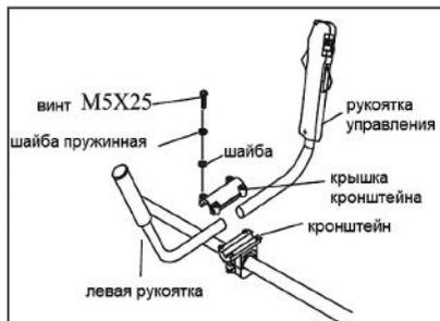
Рис. 6 Установка рукояток
