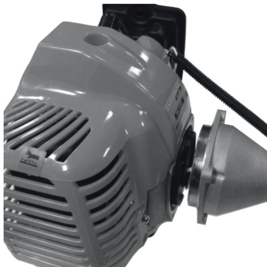
Совместите корпус чашки сцепления с передней частью двигателя. Закрутите четыре болта.
