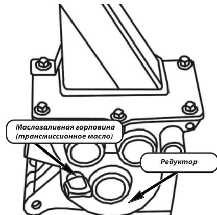
Каждый раз перед началом работы проверяйте состояние редуктора, вала редуктора, ротора и креплений. При наличии масляных пятен в нижней части редуктора или вале обратитесь в сервисный центр. Если ножи ротора пришли в негодность, приобретите новые.
