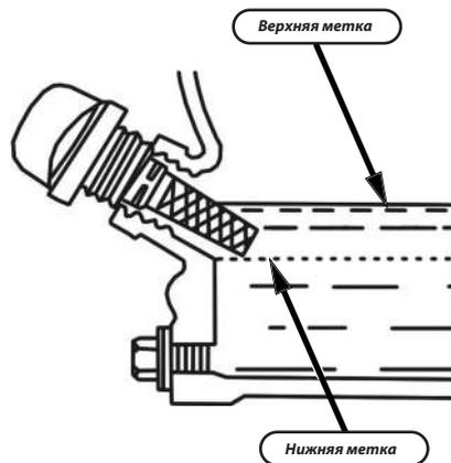
Закрутите болт сливного отверстия. Залейте новое масло до уровня, указанного на щупе. При эксплуатации измельчителя при сильной нагрузке или при повышенной температуре окружающего воздуха масло следует заменять каждые 25 моточасов. Помните, что измельчитель поставляется без моторного масла в двигателе.
