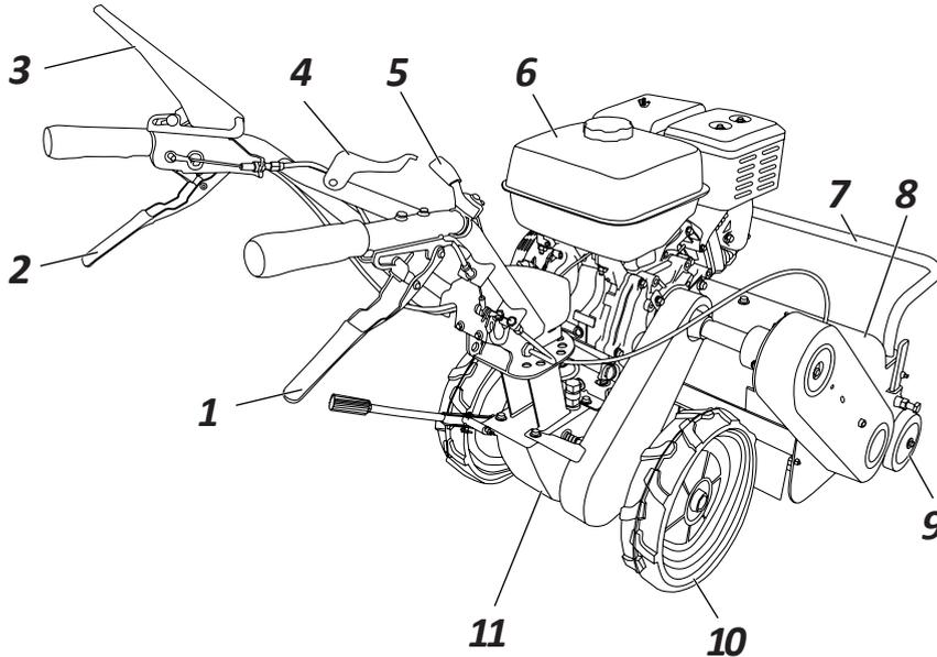
1. Рычаг включения ротора;
