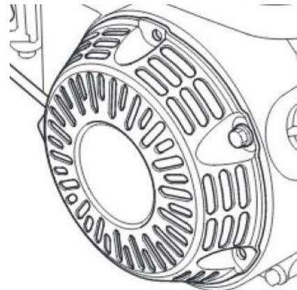
При загрязнении охлаждающих отверстий стартера продуктами измельчения растительности, пылью, масляным шламом используйте для очистки кисточку и/или баллон со сжатым воздухом.
