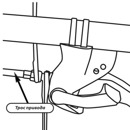
Со временем тросы привода могут растянуться. Для их регулировки необходимо расконстрировать гайку и добиться оптимального натяжения тросов. Оптимальной регулировкой троса является начало движения измельчителя при нажатом рычаге сцепления на  $\frac{1}{3}$ .
