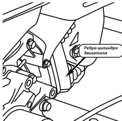
Двигатель необходимо очищать от грязи каждый раз после окончания работы с измельчителем. Грязный двигатель и загрязненные ребра цилиндра двигателя могут стать причиной его перегрева и поломки.
