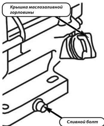
Открутите болт сливного отверстия и крышку маслозаливной горловины. Слейте отработанное масло. Произведите замену моторного масла первый раз после 5 моточасов работы. Периодичность замены моторного масла во время эксплуатации измельчителя - каждые 50 моточасов работы или 1 раз в сезон.
