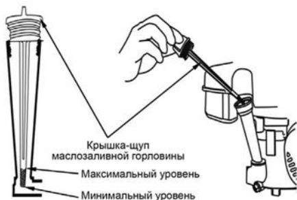
Рис. 7 Проверка уровня масла в картере
