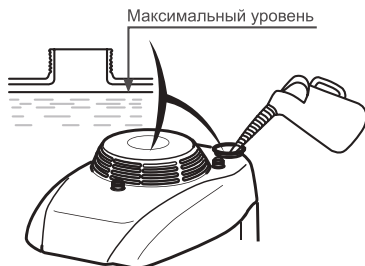
Рис. 5 Максимальный уровень топлива
