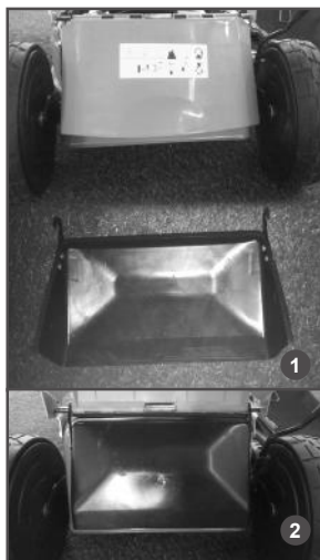
Рис. 4 Установка желоба заднего выброса
