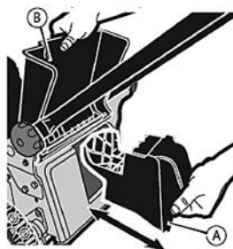
Рис. 3 Установка заглушки для мульчирования
