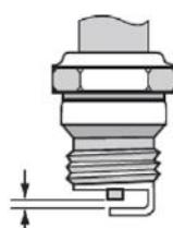
При необходимости замените свечу. Подходят следующие модели: DDE LR5YC, Champion RN9YS, Bosch WR7DC, NGK BPR6ES. Вкрутите свечу, затяните универсальным ключом, не прикладывая значительной силы. Установите колпачок и крышку в обратном порядке.
