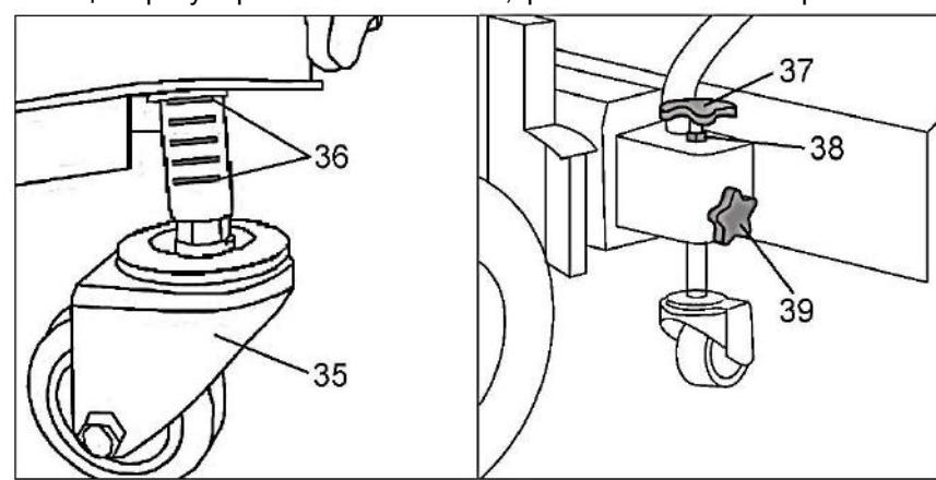
регулировки. Для обеспечения точной регулировки на вал колеса 35
