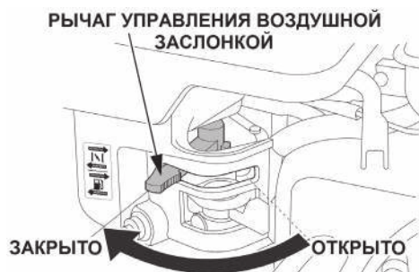
Рис. 18 Рычаг управления воздушной заслонкой
