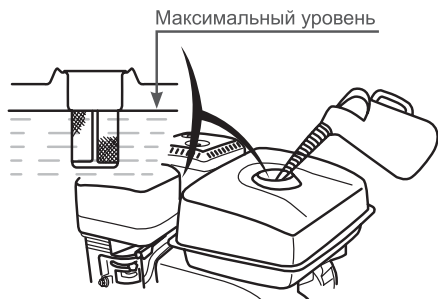
Рис. 13 Максимальный уровень топлива в топливном баке
