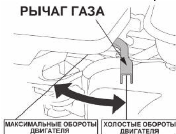
Рис. 20 Положения рычага газа
