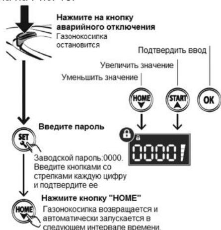
Рис. 16 Выключение газонокосилки в ручном режиме
