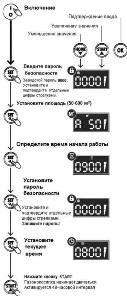
Рис. 17 Алгоритм настройки автоматического режима работы газонокосилки
