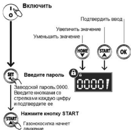
Рис. 15 Включение газонокосилки в ручном режиме
