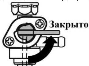
Рис. 7 Топливный кран закрыт
