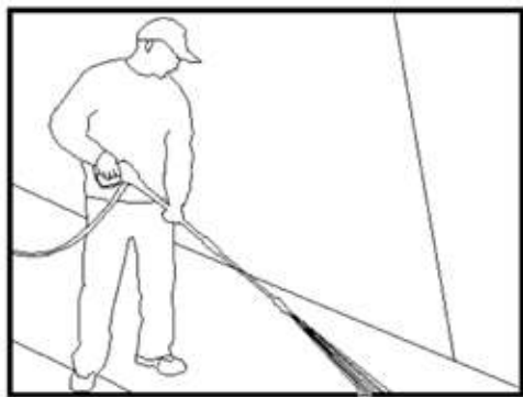
Рис. 6 - Оптимальный угол распыления воды относительно поверхности
