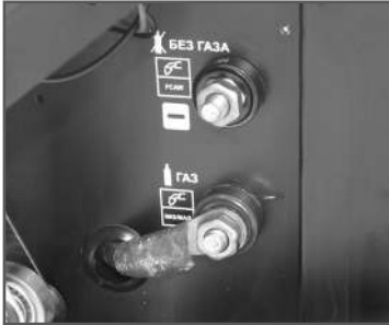
Рис. 10 Клеммы подключения кабеля механизма подачи проволоки
