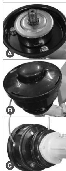
Рис. 6 Установка триммерной головки
