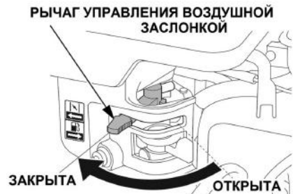
Рис. 12 Рычаг управления воздушной заслонкой
