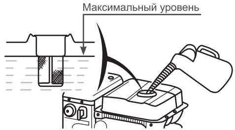
Рис. 7 Максимальный уровень топлива в топливном баке
