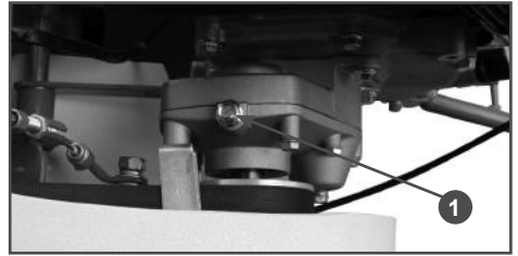
Рис. 11 Заправка масла в редуктор двигателя
