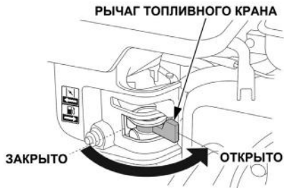
Рис. 13 Рычаг топливного крана
