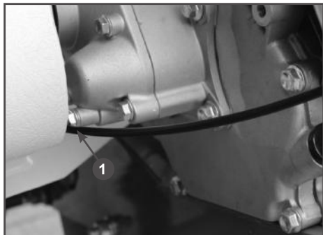
Рис. 22 Замена масла в редукторе двигателя
