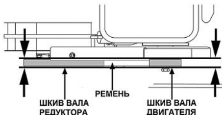
Рис. 27 Проверка соосности шкивов
