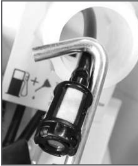
Рис.10 Извлечение топливного фильтра
