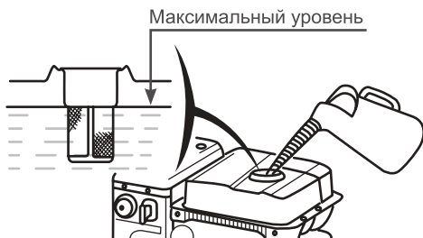
Рис. 2 Максимальный уровень топлива в топливном баке
