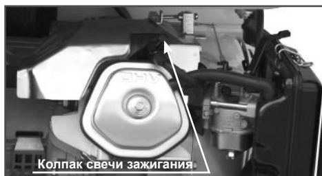
Рис. 14 Место расположения свечи зажигания
