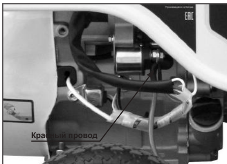
Рис. 7 Подключение плюсовой клеммы аккумулятора
